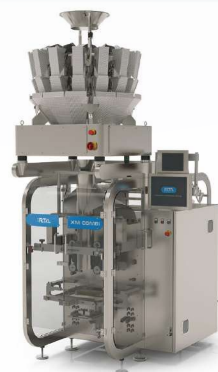
XM COMBI Envasadora TODO EN UNO Pesa + Dosifica + Envasa
