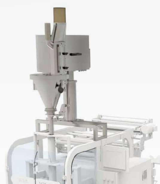
DS25-IR100 Dosificador Volumétrico Alta precisión y velocidad
